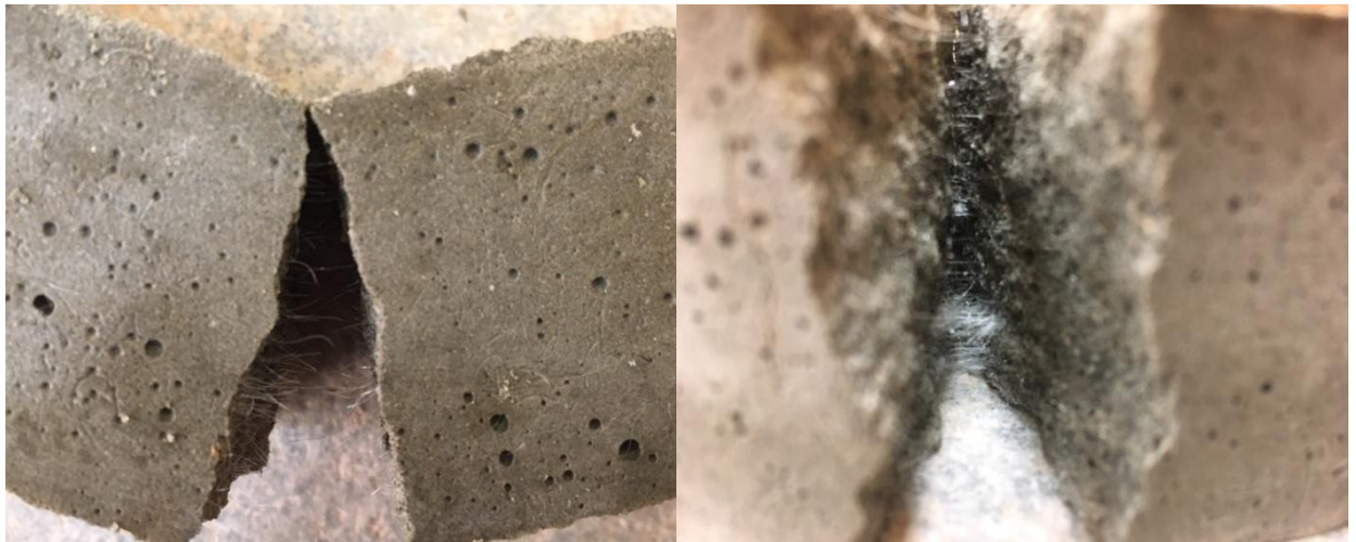
17 Сурет - Ұсақ түйіршікті бетондағы полипропилен талшығы
