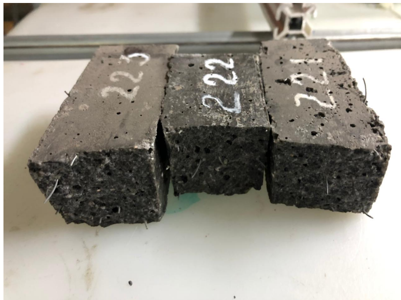
13 Сурет –Сығылуға арналған үлгілер
